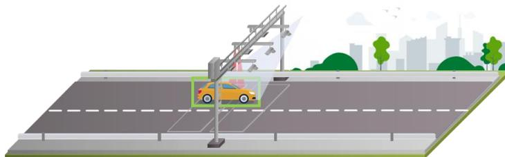
*Figura 2 – Pórtico de Identificação Automática de Veículos – Fonte: ABEPAM*
